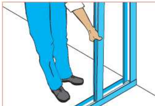
Passo 02 – Locação e fixação de montantes
