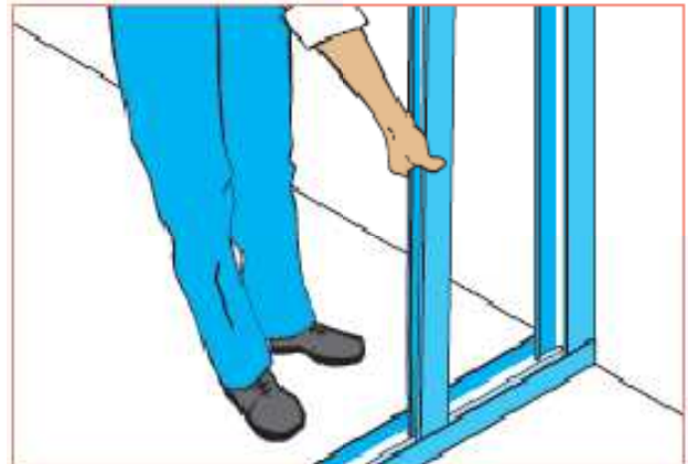
Passo 02 – Locação e fixação de montantes
