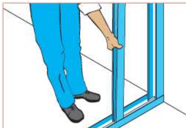
Passo 02 – Locação e fixação de montantes
